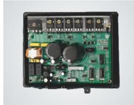
Ausgestattet mit einer bürstenlosen DC-Frequenzconvertertechnologie, die stabiler ist und die Ausfallrate niedrig hält.
