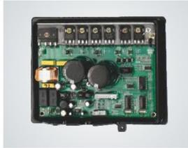
Ausgestattet mit einer bürstenlosen DC-Frequenzconverbertechnologie, die stabiler ist und die Ausfallrate niedrig hält.
